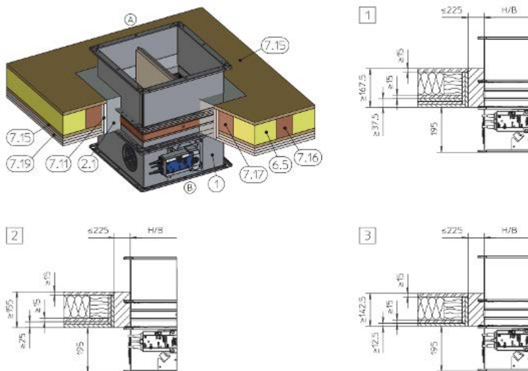
Fig. 154 : Montage au mortier dans un plafond en poutres en bois / bois lamellé-collé, suspendu (illustration à titre d'exemple, peut servir à d'autres formes de plafond)
