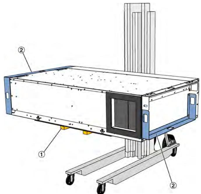
Abb. 32: Bauteil 2 auf Montagelift legen
