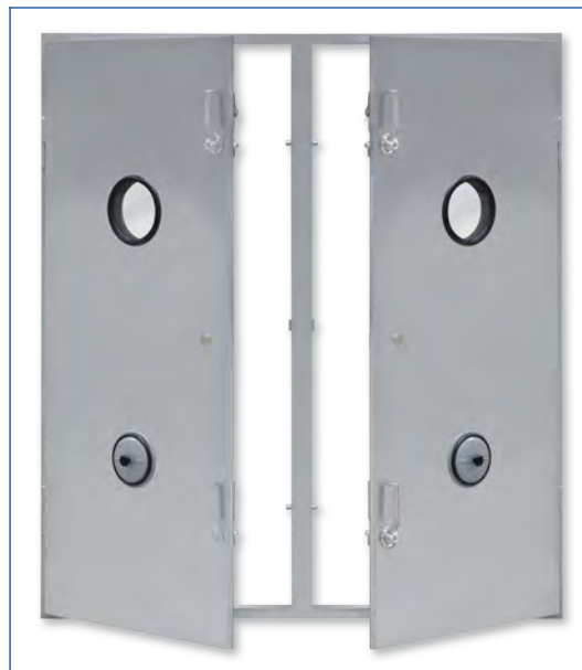
Vantail à double paroi avec fenêtre d'inspection, soupape de compensation de pression et serrure à cylindre
