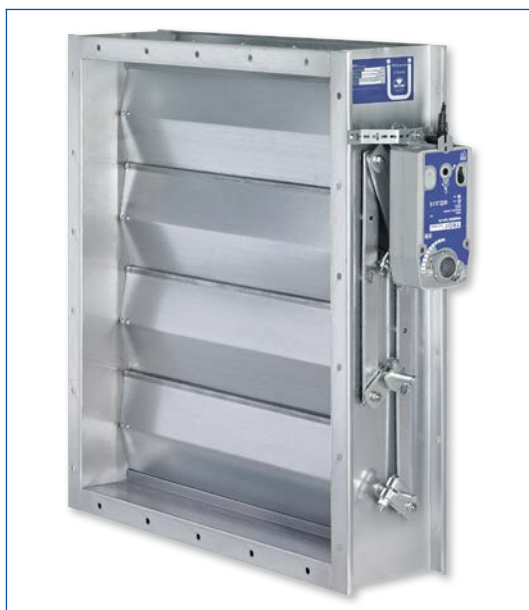
Rookklep met servomotor, flenzen aan beide zijden geboord
