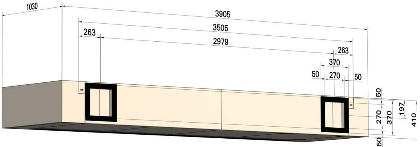
**Exécution Z : composée de deux parties : le châssis et l'unité de ventilation.**
