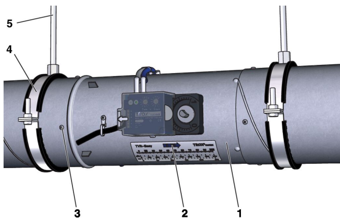
Abb. 9: Einbaubeispiel anhand eines VVS-Regelgerätes TVR-*
