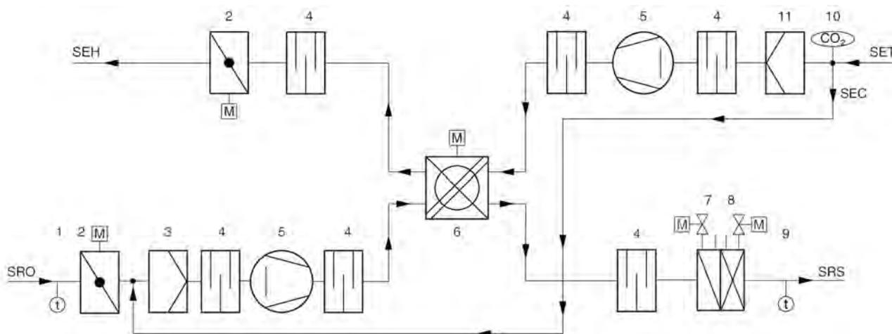
Abb. 7: Lüftungsschema SCHOOLAIR-V-HV
