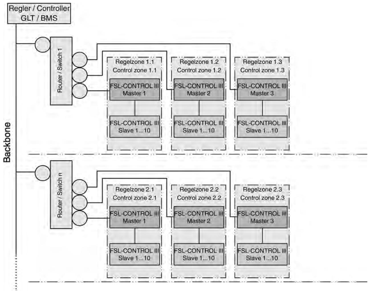
Abb. 28: FSL CONTROL III Netzwerkaufbau, Modbus TCP; BACnet IP
