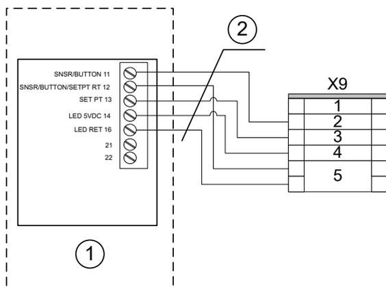
Abb. 13: Verdrahtung Raumbediengerät STR 504 an Klemme X9
