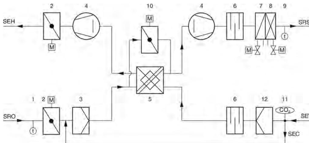
Abb. 6: Lüftungsschema FSL-V-ZAB/SEK / SCHOOLAIR-V / -V-1800 / -V-HE
