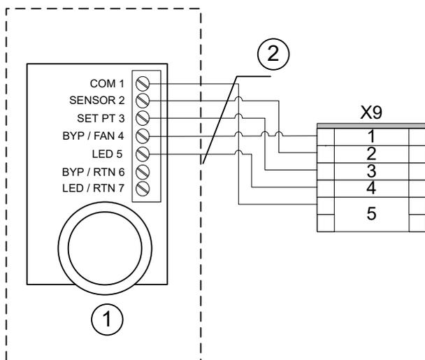
Abb. 12: Verdrahtung Raumbediengerät Honeywell, 5-stufig an Klemme X9
