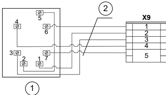
Abb. 16: Verdrahtung Raumbediengerät Berker S.1 an Klemme X9
