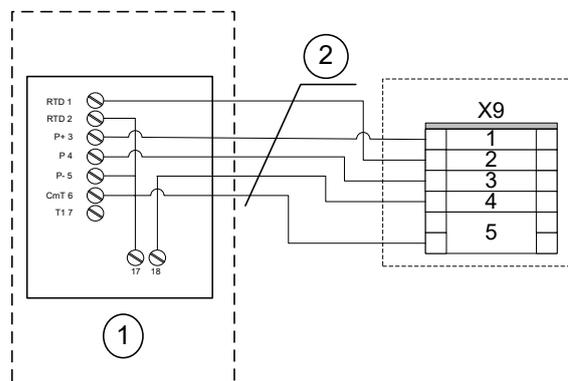
Abb. 14: Verdrahtung Raumbediengerät Titec RTF3-NTC20k-P5k-T-L an Klemme X9
