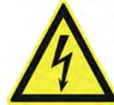
Dieses Schild weist auf eine gefährliche elektrische Spannung hin, die im Lüftungsgerät anliegt. Arbeiten an Teilen des Lüftungsgeräts, die mit diesem Schild gekennzeichnet sind, dürfen nur von Elektrofachkräften durchgeführt werden. Für diese Arbeiten muss eine Elektrofachkraft oder der technische Service kontaktiert werden.
