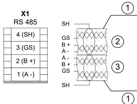
Abb. 25: Anschluss GLT an Master-Gerät mit Modbus RTU
