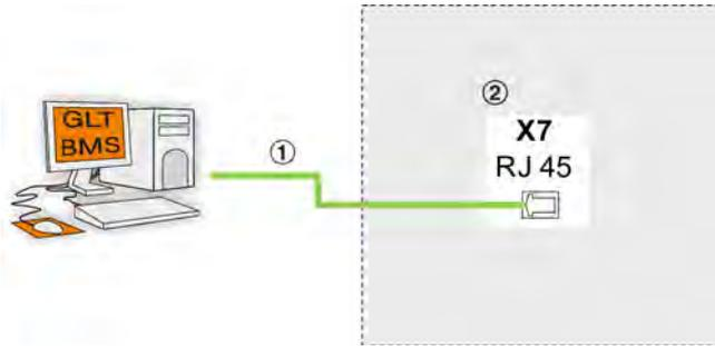
Abb. 26: Anschluss GLT an Slave-Gerät mit Modbus TCP
