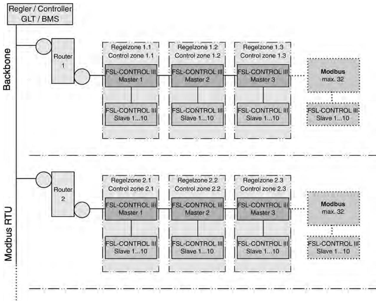
Abb. 27: FSL CONTROL III Netzwerkaufbau, Beispiel Modbus RTU; BACnet MS/TP
