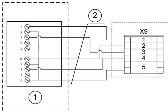
Abb. 17: Verdrahtung Raumbediengerät Thermokon an Klemme X9
