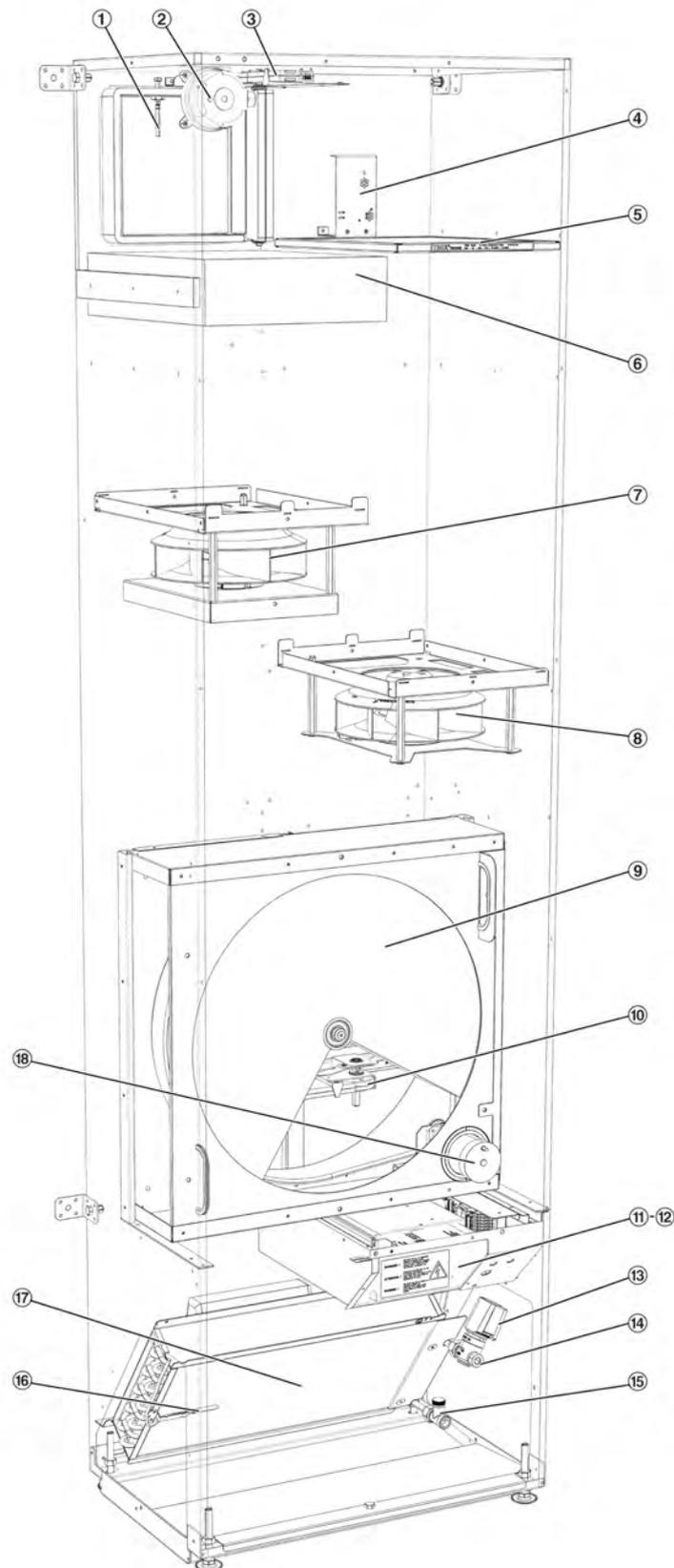
Abb. 38: Ersatzteile SCHOOLAIR-V-HV
