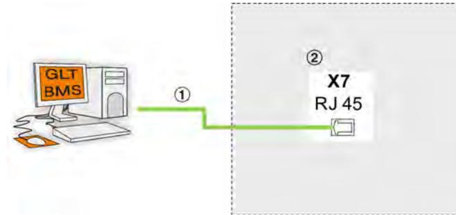
Abb. 24: Anschluss GLT an Master-Gerät mit Modbus TCP / BACnet IP
