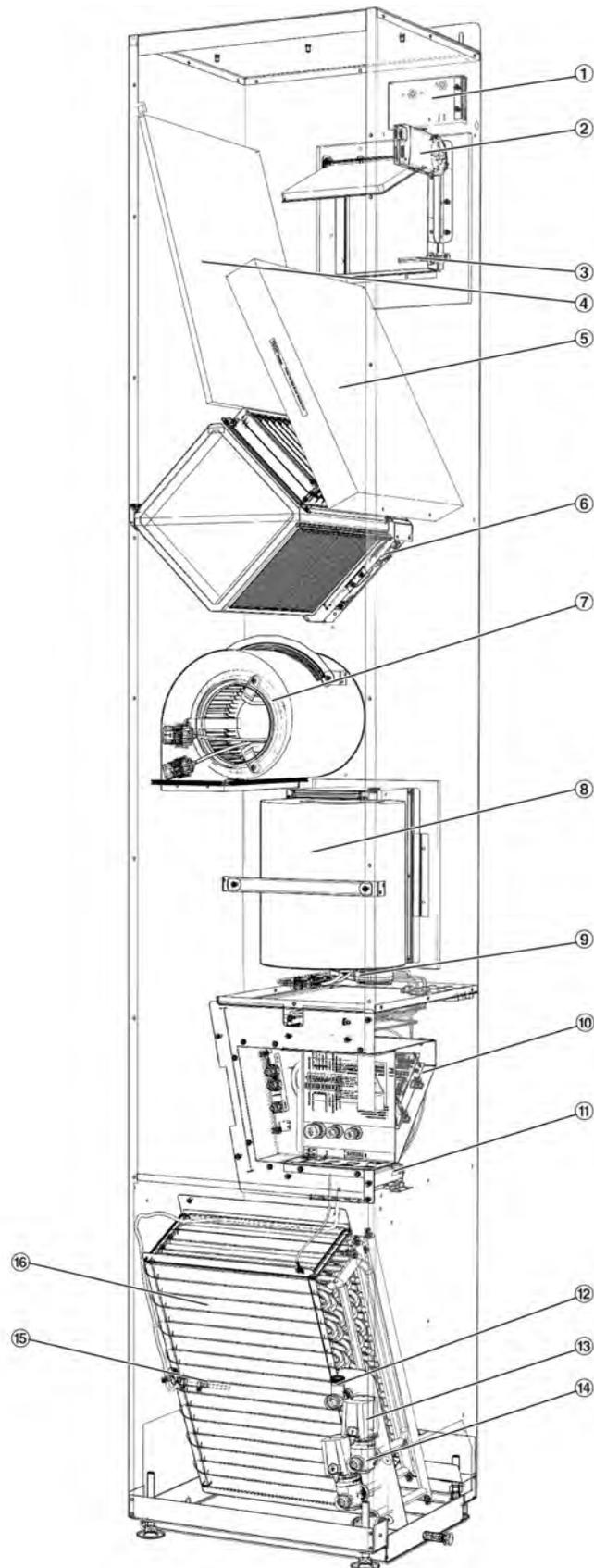
Abb. 35: Ersatzteile SCHOOLAIR-V
