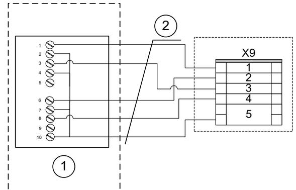
Abb. 18: Verdrahtung Raumbediengerät Thermokon an Klemme X9
