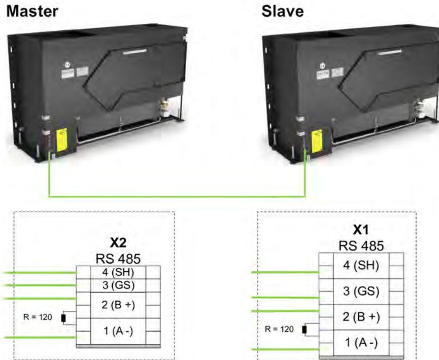
Abb. 21: FSL CONTROL III Kommunikation 2 Geräte
