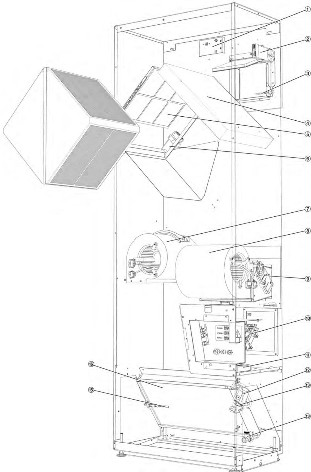
Abb. 36: Ersatzteile SCHOOLAIR-V-1800, Wärmerückgewinner herausgezogen
