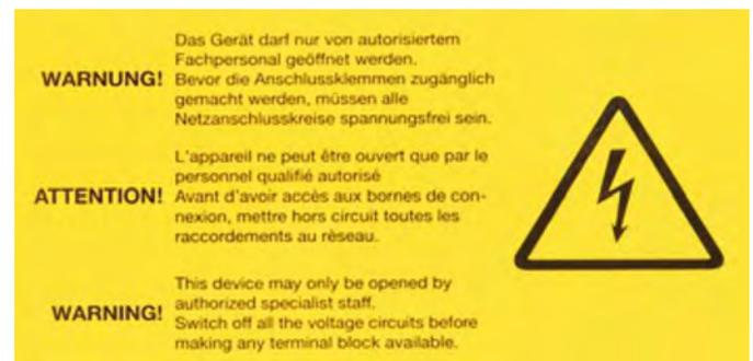
Dieses Schild weist darauf hin, dass der Revisionsdeckel Regelung nur von einer Elektrofachkraft geöffnet werden darf. Bevor die Anschlussklemmen zugänglich gemacht werden, müssen alle Netzanschlusskreise spannungsfrei sein.
