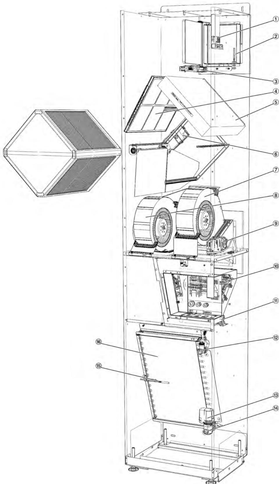
Abb. 34: Ersatzteile FSL-V-ZAB/SEK, Wärmerückgewinner herausgezogen
