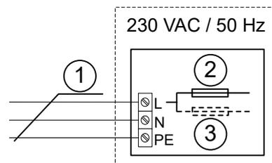
Abb. 11: Anschluss Versorgungsspannung
