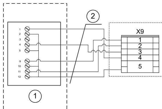
Abb. 15: Verdrahtung Raumbediengerät Thermokon an Klemme X9
