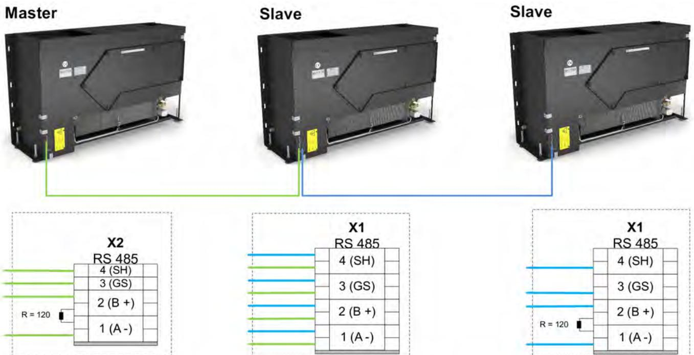
Abb. 22: FSL CONTROL III Kommunikation 3 Geräte
