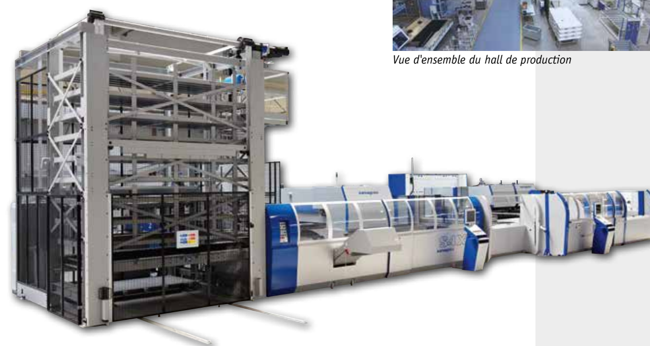
Centre d'usinage de la tôle ultra-moderne pour la production de panneaux
