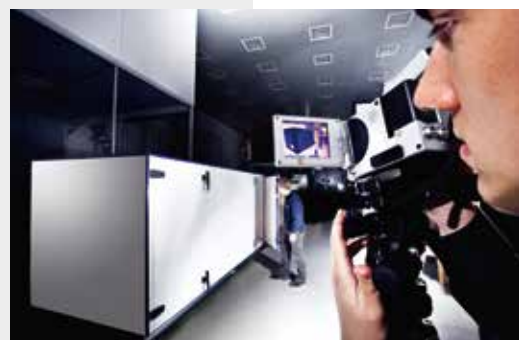
Imagerie thermique du prototype.
