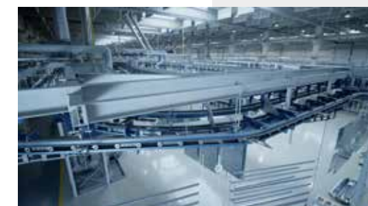
Transport automatique vers la peinture par pulvérisation
