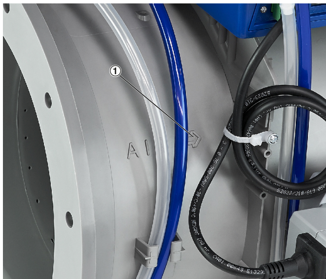
Abb. 9: Luftrichtungspfeil am TVLK
