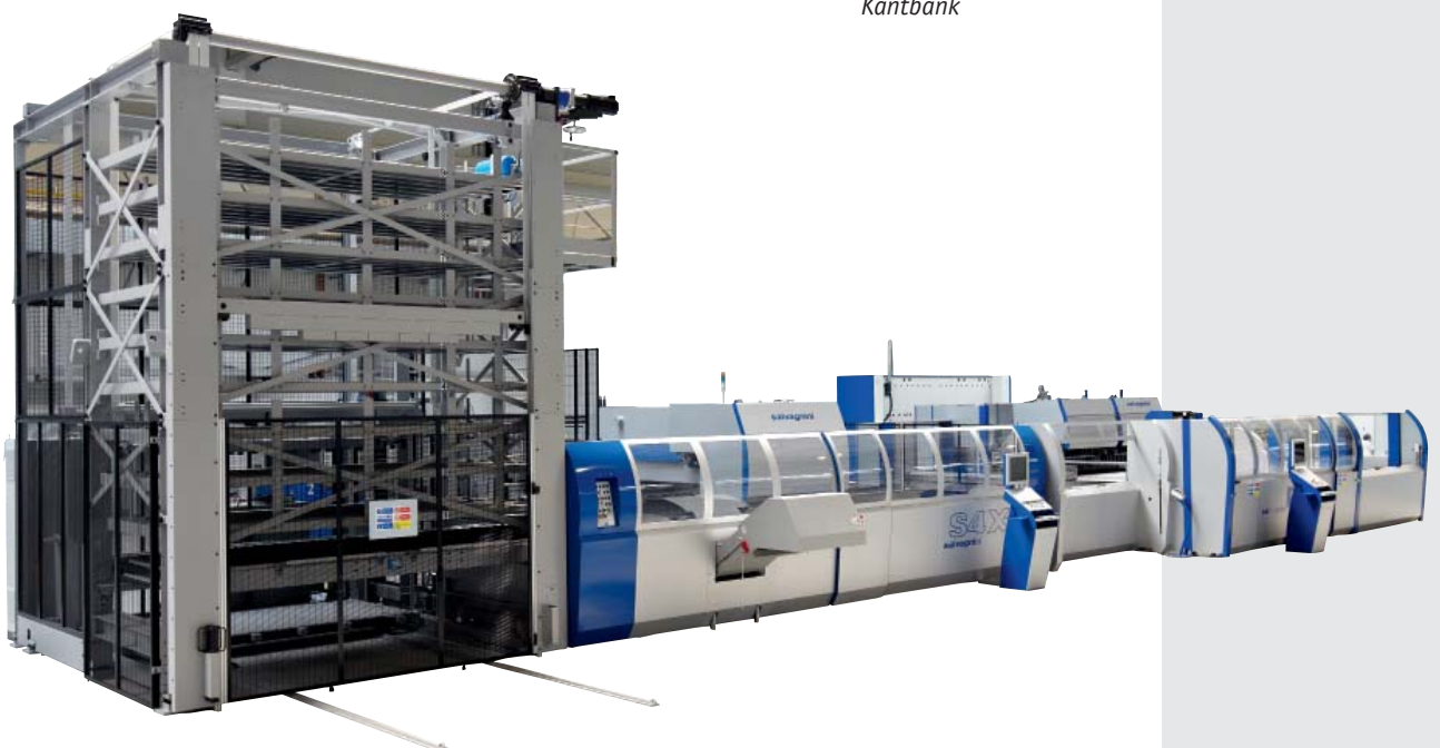
Het moderne plaatbewerkingscentrum voor de paneelproductie
