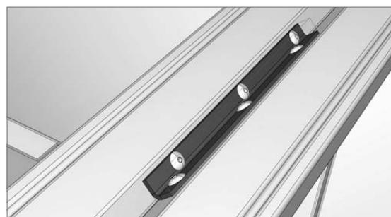
Bild 5: Verbindungswinkel aufnieten
