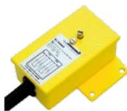
Zur End- oder Zwischenstellungssignalisation können externe, einstellbare, explosionsgeschützte Hilfsschalter Type ExSwitch nachgerüstet werden. Das Hilfsschaltergehäuse wird direkt in den antriebsseitigen Doppelveikant gesteckt und mit dem Antrieb verschraubt. Die beiden Hilfsschalter haben je einen potenzialfreien Umschaltkontakt und sind unabhängig voneinander justierbar. Der Anschluss erfolgt über Kabelschwanz.
