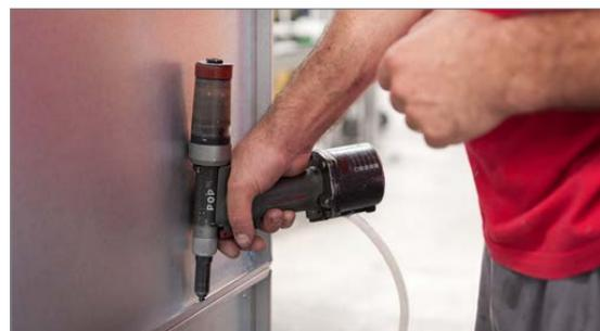
Bild 4: Flansche der Seitenwände aufeinandernieten
