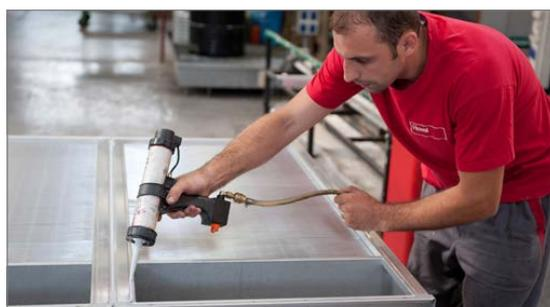
Bild 3: Dichtmasse auftragen
