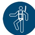
Der Auffanggurt dient zum Schutz vor Absturz bei erhöhter Absturzgefahr. Diese besteht, wenn bestimmte Höhenunterschiede überschritten werden und der Arbeitsort nicht durch ein Geländer gesichert ist.
