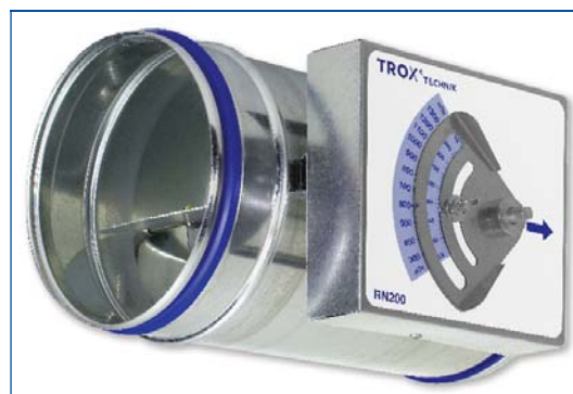
Régulateur CAV, version RN avec servomoteur pour commuter entre valeurs de consigne
