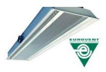
Avec ce modèle aux multiples atouts : ... atteignez une puissance de refroidissement inégalée en présence de faibles débits d'air (en moyenne de 15% supérieure aux produits concurrents) : 940 watt pour 45 m3/h d'air primaire (pour une longueur de poutre de 1200 mm),
