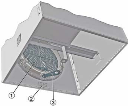
Afb. 23: Inregelklep maximaal gesmoord 90° (alleen bij aansluitkast)
