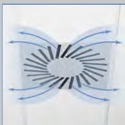
Tweezijdige, horizontale uitblaas
