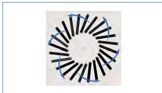
Alle luchtrichtelementen op buitenwervel
