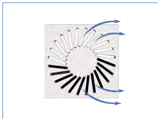
Instelling van luchtrichtelementen
